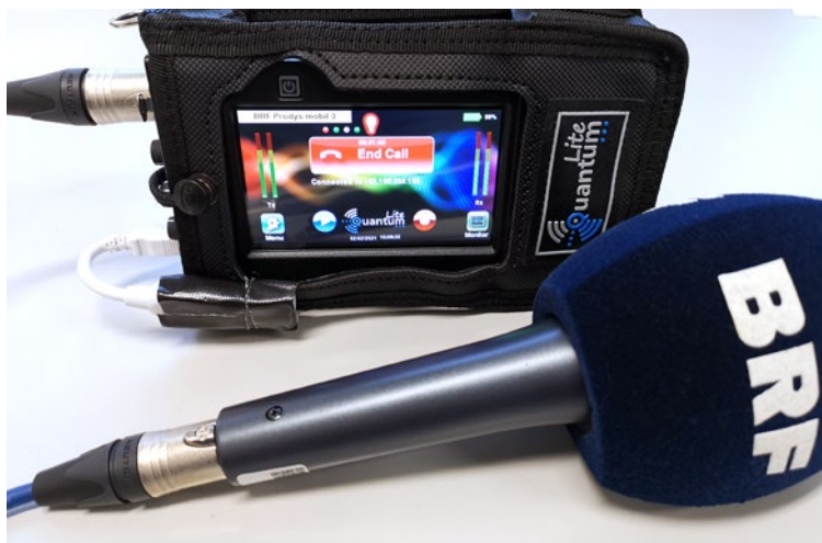
Mobiles Übertragungsgerät Prody Quantum Lite: Ermöglicht stabile Übertragungen über das Internet.
