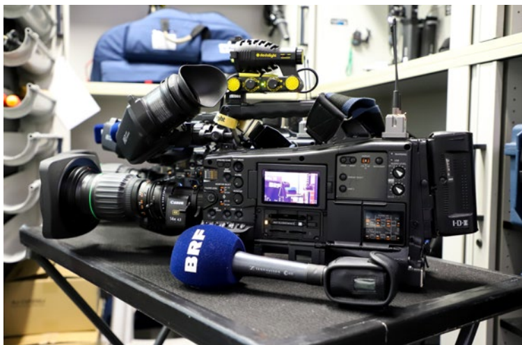
Die neue ENG-Ausrüstung für BRF-TV: Kamera Panasonic AJ-PX5100GJ mit Objektiv Canon CJ14ex4.3B IASE-S und Sennheiser Funkstrecke.
